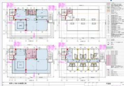
完成図面（赤字が加筆修正部分）
